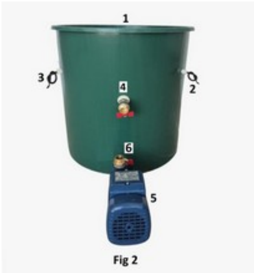
Fig.2 este prezentat bazinul hidrodinamic în detaliu: 1. corpul bazinului, 2. racord electric senzor nivel (pomă submersibilă), 3. racord electric senzor nivel (pomă de suprafață 5) , 4. racord cu robinet pomă submersibilă, 5. pompa de suprafață alimentare Pomă de căldură, 6. racord Pomă de căldură
